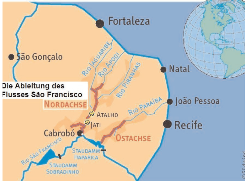
Abbildung der Abteilung - Quelle: Südwind
